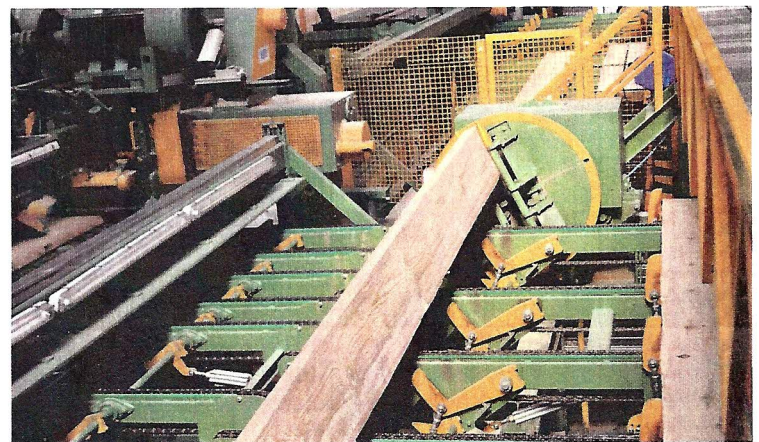
Die Schnitthölzer werden in einem ersten Arbeitsschritt mittels zweier Klemmen gewendet.
