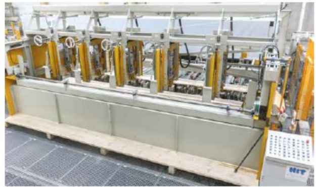
Stapelmaschine mit vorgelagerter Durchlaufkappung und automatischer Lattelegung
