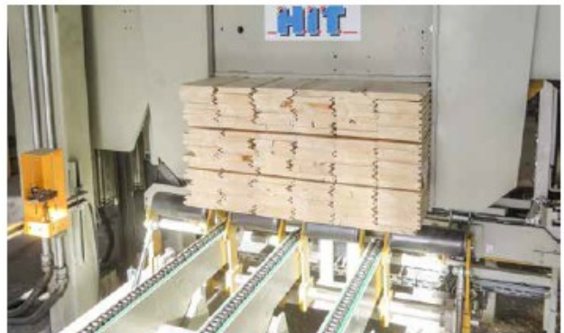
Paketpresse in Kombination mit der automatischen Umreifung und Kantholzeinschub
