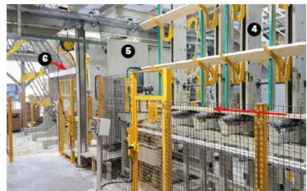
4) Übernahme der Hölzer aus der oberen Etage zur Übergabe auf die Beschickung zur Trennbandsäge, 5) Trennbandsäge, 6) Übernahme der Hölzer nach der Säge, Abtransport auf die zweite Etage zum Hobel
