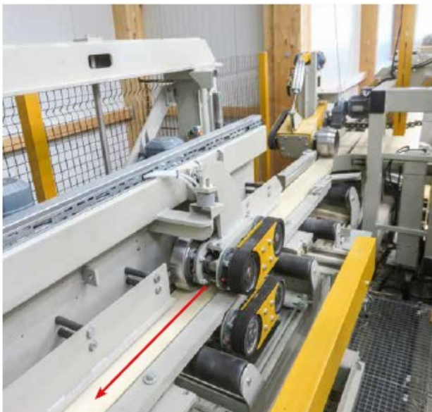
Hobeleinzug mit Aufholstrecke zum Schließen der Brettlücken
