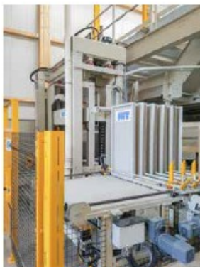
Kantholzmagazine an der Paketumreifung
