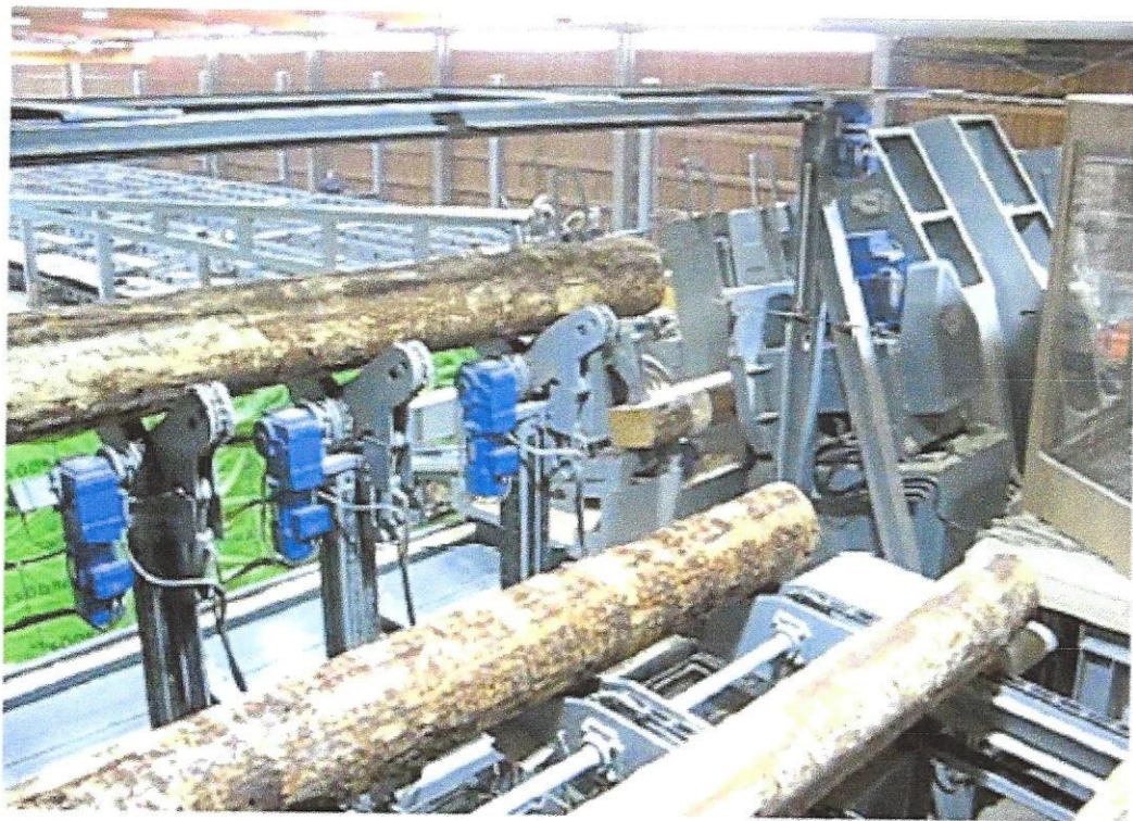
Der Stamm wird zur Vermessung hydraulisch angehoben.
