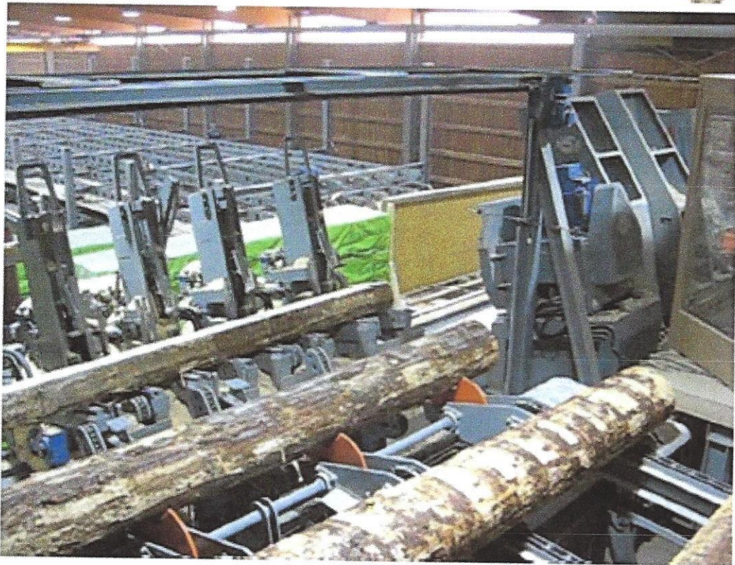
Stammübergabe vom Querförderer auf den hydraulischen Stammausheber mit elektrisch angetrieben Drehketten.
